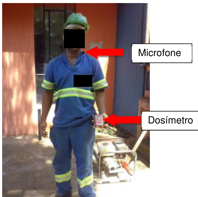
Figura 31 – Dosímetro de ruído instalado no trabalhador. Fonte Arquivo Pessoal.
